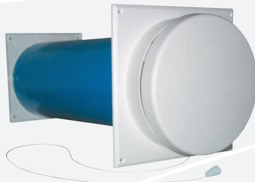
Přívodní prvek vzduchu zabezpečuje konstantní proud vzduchu do obytných místností, bytů, domů a kanceláří. Otevření a uzavření přívodního prvku se ovládá tažným lankem. Minimální množství vzduchu je nastavitelné seřizovacím šroubkem za vnitřním krytem.
